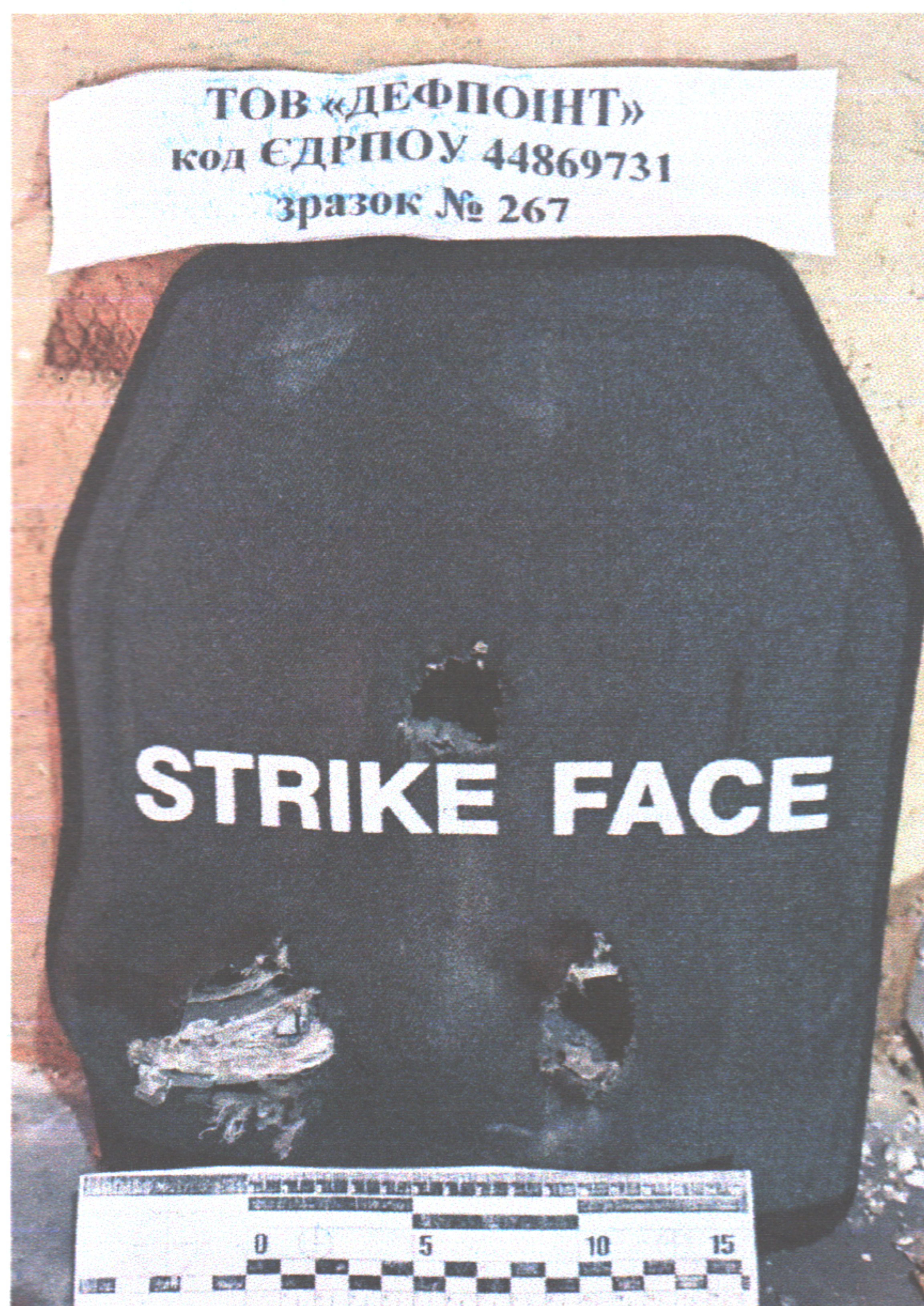
Фото 1.1.1. Зразок до та після випробування (за нормальних умов).
